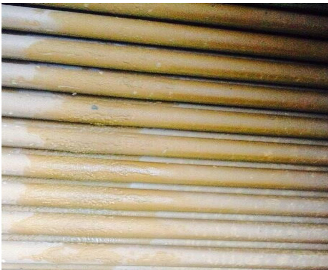
Фото осадка (толщина до 2 мм.) извлеченного с трубок холодильника тех.поз. [REDACTED] до химической очистки:
